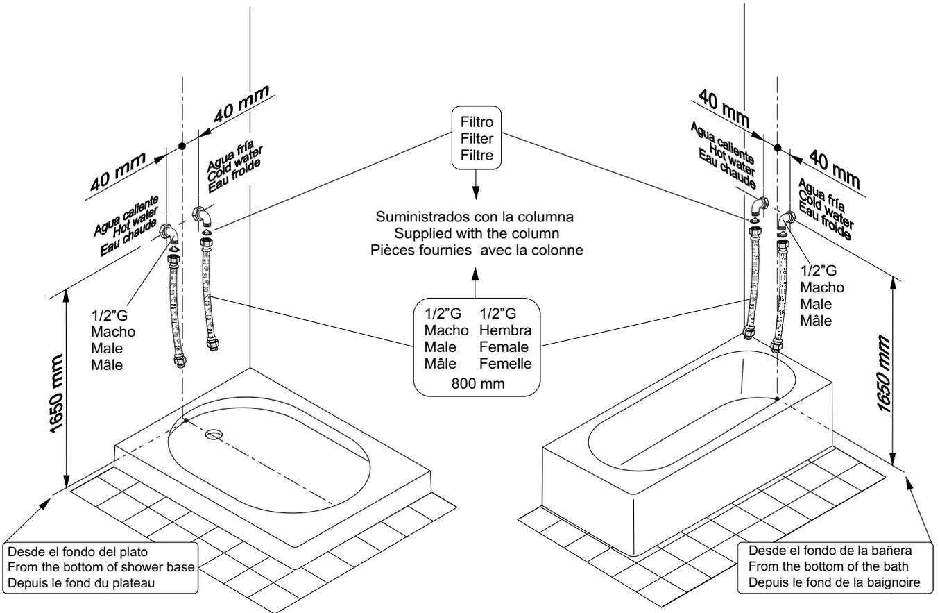
INSTALACIÓN EN RINCÓN - INSTALLATION IN CORNER - INSTALLATION DANS UN COIN
